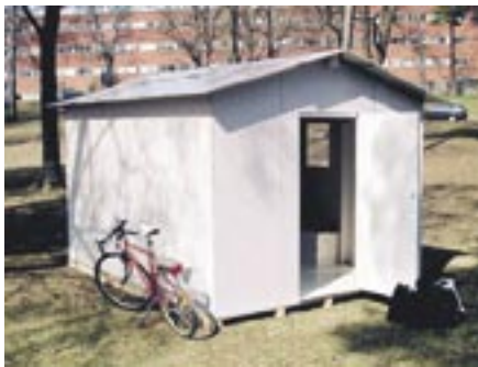
Das tragbare Haus aus dem Pappmaterial PHIR wird platt verpackt transportiert und ist im Nu montiert
